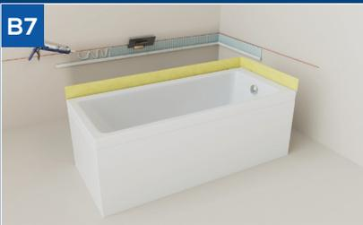
In der Höhe des Wannendichtbandes den ET-S CLASSIC FLEX Klebdichtstoff flächig auftragen. Zahnpachtel 3x3 mm verwenden.
