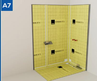
Die auf Maß abgelängten Dichtbänder mittels CLASSIC FLEX Klebedichtstoff in allen Ecken, Wand-Wand und Wand-Boden, sowie Stoßverbindungen verlegen.
