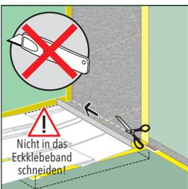
**C 11.** Anschließend mit der Schere die Dichtbahn entlang der Markierung sauber abschneiden. **Vorsicht: Eckklebeband nicht beschädigen!**
