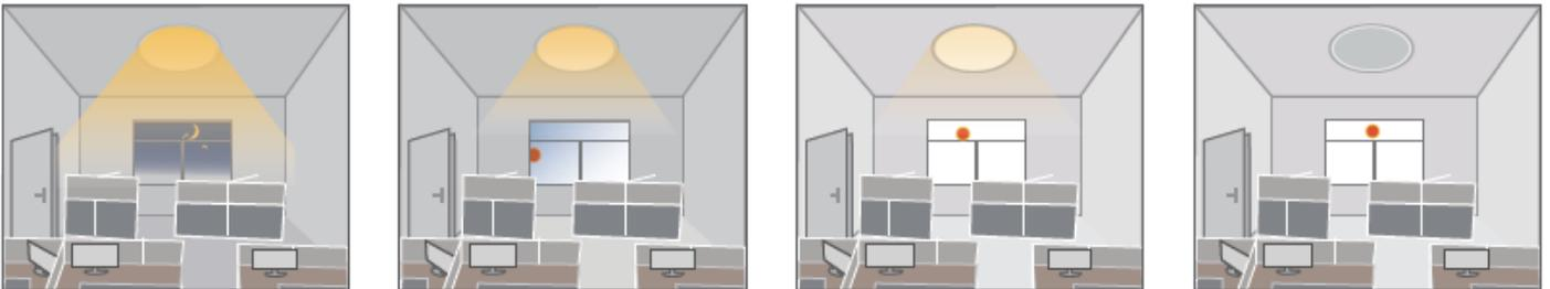
Quando i livelli di luce ambientale scendono al di sotto del livello di lux impostato, il sensore regolerà l'apparecchio compensare (ad es. se i livelli ambientali aumentano, la luminosità dell'apparecchio diminuirà).
