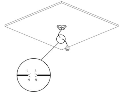
Rispettare la polarità linea e neutro, mediante l'utilizzo di un morsetto non fornito.
