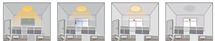
Lorsque les niveaux de lumière ambiante sont inférieurs au niveau de Lux défini, le détecteur ajuste le luminaire pour compenser (par ex., si les niveaux ambiants augmentent, la luminosité du luminaire diminue).
