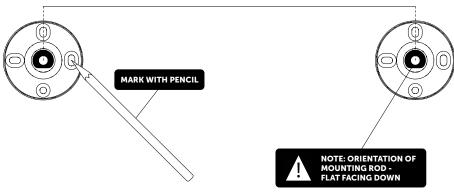
3 DRILL HOLES IN WALL / SURFACE AND INSERT WALL PLUGS.
