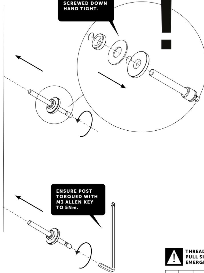
**!** **THREADED SIDE MUST ALWAYS BE ON PULL SIDE OF DOOR FOR SECURITY / EMERGENCY EXIT USE.**
