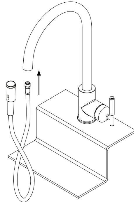
**B6** UNSCREW THE TENSILE CLAMPS.
